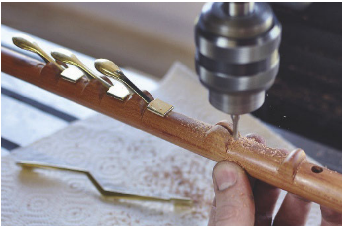
/ Hohe Wiederholgenauigkeit: Die Längsschlitzte zur Aufnahme der federnd gelagerten Klappen werden auf einem CNC-gesteuerten Bohr- und Fräszentrum ausgeführt.
