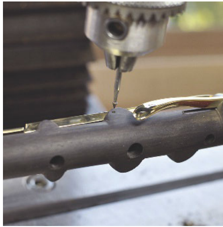
/ Der präzise Sitz der Löcher für die Klappenlager wird auf ein einer konventionellen Fräsmaschine angekörrt.
