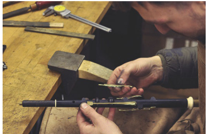
/ Höchste Präzision: Jede der aus massivem Messing von Hand gefertigten und federnd gelagerten Klappen wird in die Haltenocken der Pfeife exakt eingepasst.
