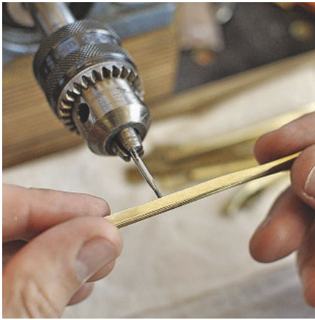
/ Auf dem Bohrbänkchen werden metrische Gewinde (M 1,4) in die Klappen aus Messing geschnitten.
