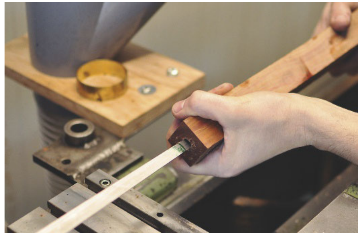
/ Mit vollem Körpereinsatz wird der vorgebohrte Luftkanal in den Kanten der Pfeifen mit einem speziell angefertigten, konischen Räumernachgearbeitet.
