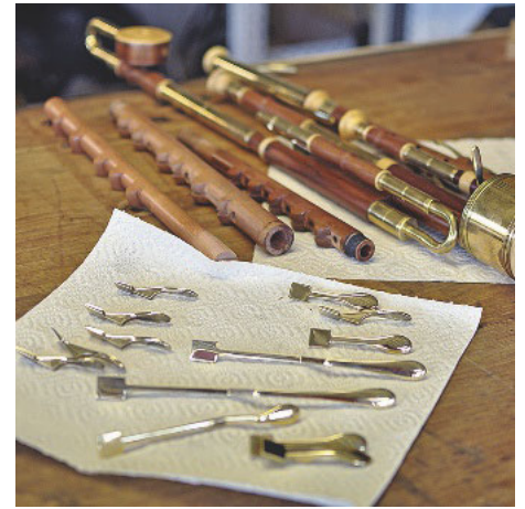
/ Ein fein geschliffener und polierter Klappensatz aus Messing, fertig zur Endmontage auf dem Instrument.
